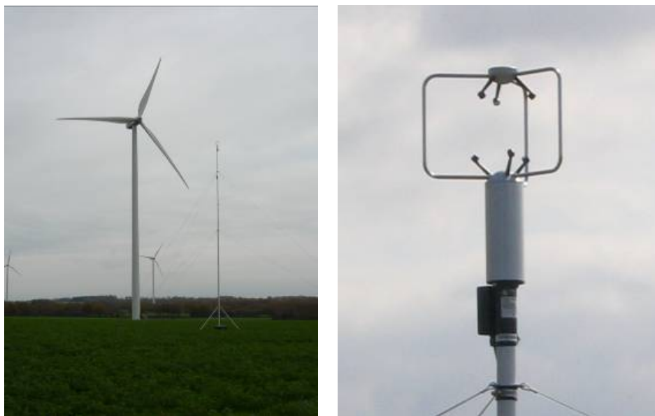
Figure 58 : mât météorologique de 10 m de hauteur (à gauche) comportant un anémomètre à ultrasons 3D (à droite), installé au point M
