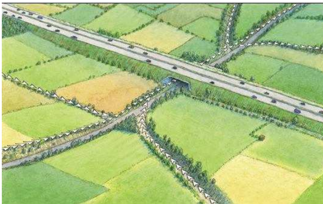
Schéma de principe de la connexion à l'ouvrage existant sous la D65
